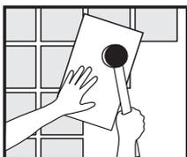
**5. Peças Convencionais:** colocar a peça 5 cm antes da posição final e arrastá-la até a posição final. Apertar com as mãos e bater com martelo de borracha sobre a peça toda para esmagar os cordões da argamassa. Porcelanatos Finos: colocar a peça 5 cm antes da posição final e arrastá-la até a posição final. Recomenda-se utilizar ventosas em peças de grandes formatos para facilitar o deslize da peça. Bater com desempenadeira de borracha para esmagar os cordões de argamassa para não quebrar.
