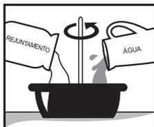
1. Em recipiente de plástico ou metal limpo e seco, misturar de forma manual ou mecânica o rejuntamento em pó juntamente com água limpa até formar uma massa pastosa, firme e sem grumos secos. Para não interferir no tempo de pote do rejuntamento, aconselha-se trabalhar com o produto ao abrigo do sol, vento e chuva. Não adicionar nenhum componente além de água.
