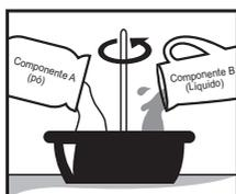
2. Em recipiente de plástico ou metal limpo e seco, misturar a argamassa em pó com água limpa, conforme a tabela abaixo, até formar uma massa pastosa, firme e sem grumos secos. Misturar manualmente ou com hélice acoplada à furadeira. Trabalhar com o produto ao abrigo de sol, vento e chuva, para não interferir no tempo de pote da massa.
