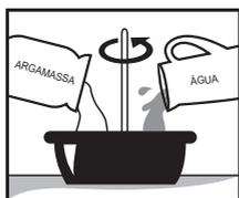
1. Em recipiente de plástico ou metal limpo e seco, misturar preferencialmente com hélice acoplada à furadeira todo o conteúdo da embalagem: 15,2 kg do componente A (pó) mais 4,8 litros do componente B (líquido) até formar uma massa pastosa, firme e sem grumos secos.
