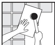
4. Colocar a 5 cm antes da posição final e arrastá-la até a posição final, apertar com as mãos e bater com martelo de borracha sobre a peça toda para esmagar os cordões da argamassa.
