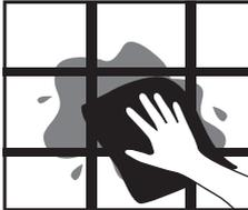
6. Molhar levemente a superfície das peças e as juntas com água limpa antes de rejuntar, pois torna o processo de aplicação do rejunte mais fácil e o revestimento mais limpo.
