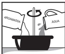
1. Em recipiente de plástico ou metal limpo e seco, misturar a argamassa em pó com água limpa até formar uma massa pastosa, firme e sem grumos secos. Misturar manualmente ou com hélice acoplada à furadeira. Trabalhar com o produto ao abrigo de sol, vento e chuva, para não interferir no tempo de pote da massa.
