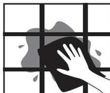
4. Após 6 horas da aplicação, limpar somente as peças com pano levemente úmido para remover os resíduos de produto sobre o revestimento.
