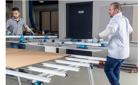
Imagen 93: Movimiento de la pieza para la mesa de corte forrada.
