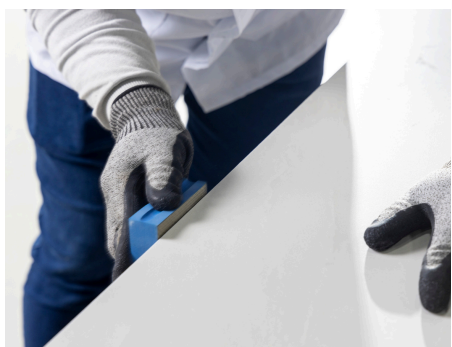
Imagen 100: Uso de la esponja diamantada para acabado fino.
