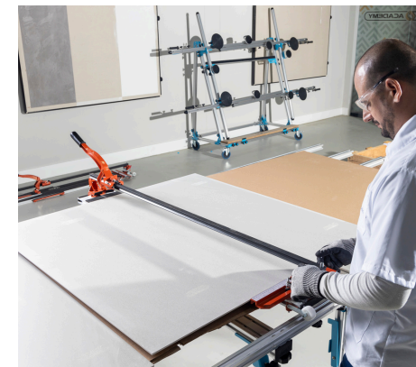
Imagem 51: Encaixa da peça estabilizada sobre o riscador.
