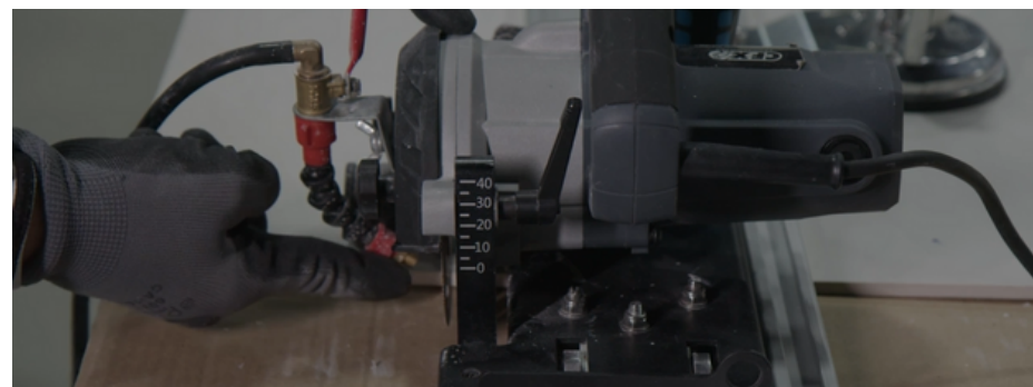
Imagen 74: Ajuste la palanca según la profundidad de corte.
