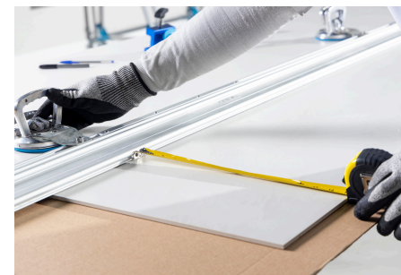
Imagem 59: Marcação do encaixe do trilho.
