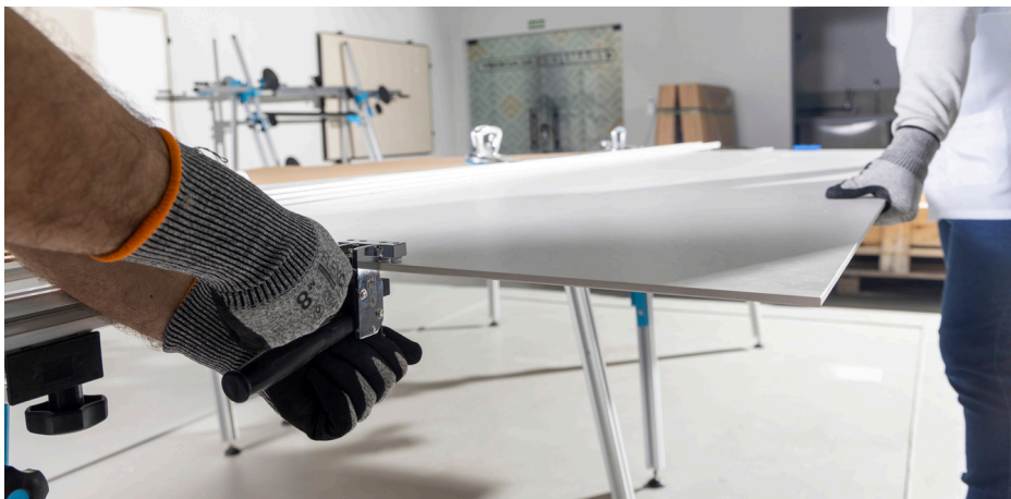
Imagen 67: En uno de los lados, gire la manivela del alicate hasta la apertura parcial del corte.
