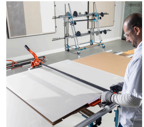
Imagen 51: Encaje de la pieza estabilizada sobre el rayador.
