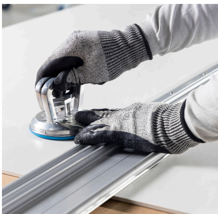
Imagem 94: Fixar o trilho com ventosa na peça.
