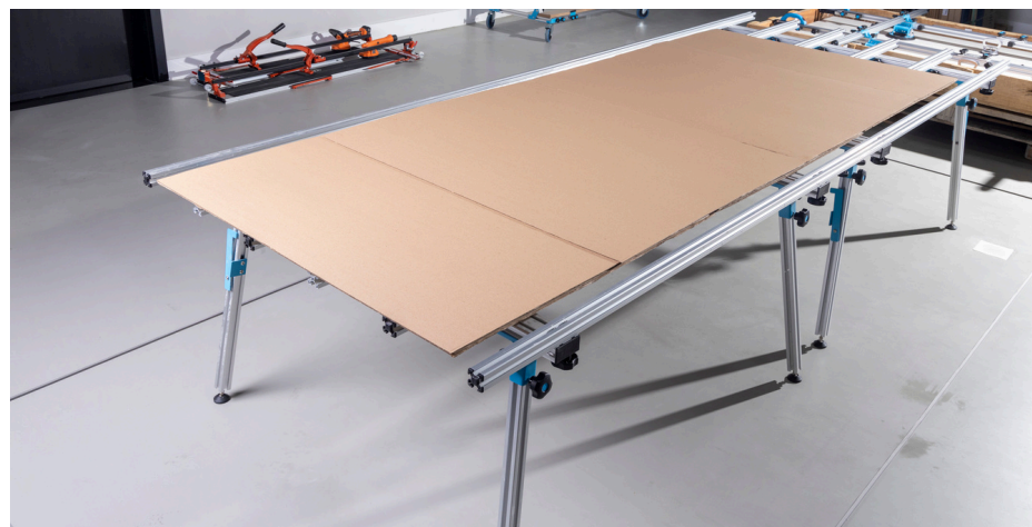
Imagem 47: Mesa de corte forrada com papelão.
