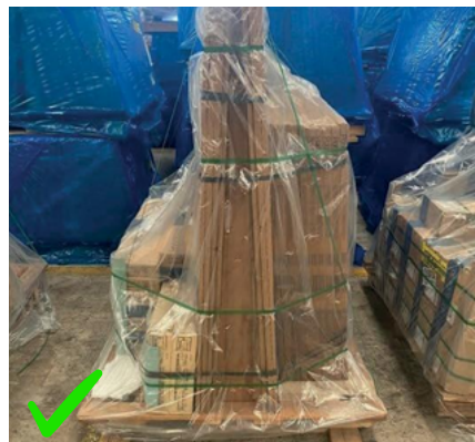
Imagem 02: Armazenamento em área coberta.
