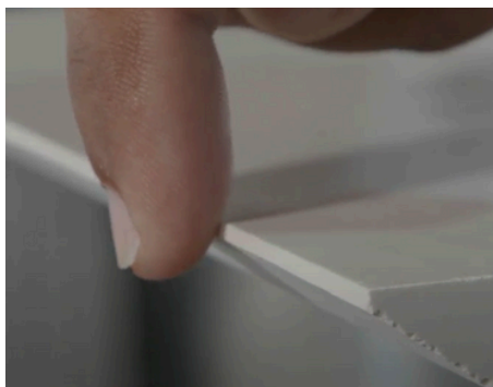
Imagen 98: Los 2 mm que el disco no cortó.
