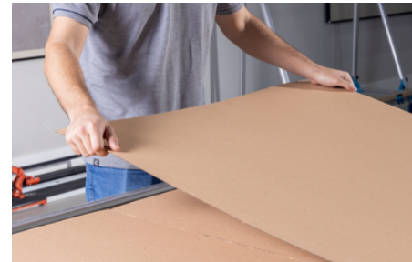
Imagen 92: Forrado de la mesa de corte con cartón.
