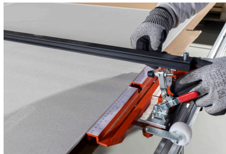
Imagem 53: Ajuste a vidade diamantada do riscador na marcação.
