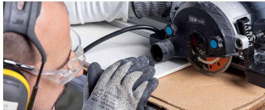
Imagen 73: Verificar si el disco está en el lugar de corte.
