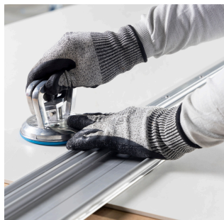
Imagem 61: Fixar o trilho com ventosa na peça.
