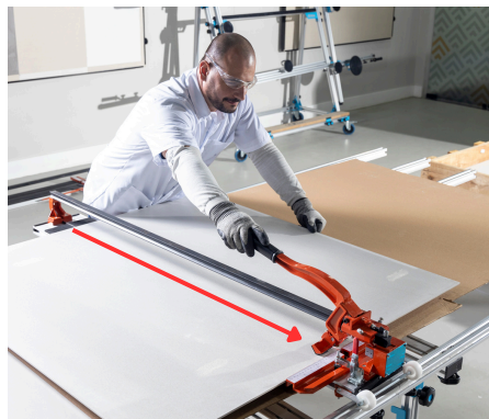
Imagen 55: Complete la marca, empujando la guía de un extremo a otro.
