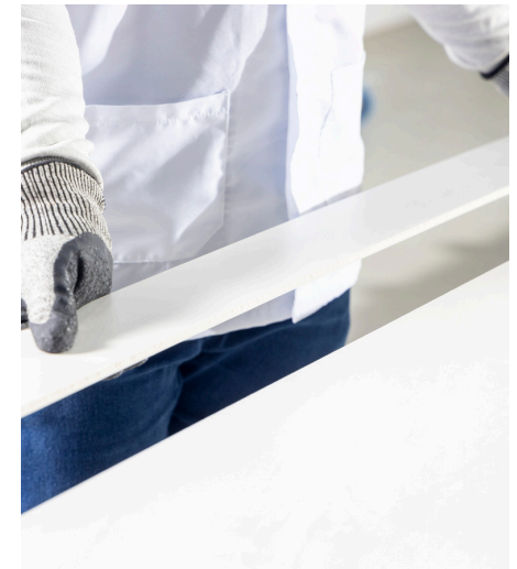
Imagen 69: Luego de ejercer presión en el centro de la pieza, la marca se rompe por completo.
