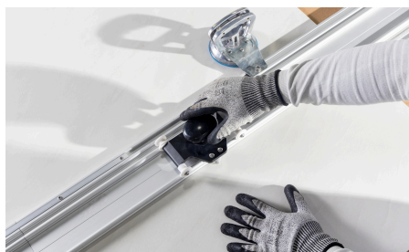
Imagem 62: Encaixe o rodel sobre o trilho
