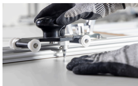
Imagem 63: Confira se o riscador encaixa no local do corte.
