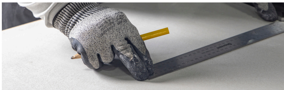
Imagen 84: Dibuje en la pieza el corte que se va a realizar.
