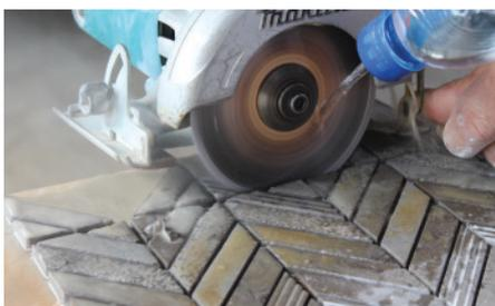
**Foto 17:** Corte com serra mármore e disco diamantado para porcelanato refrigerado com água
