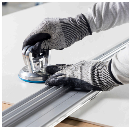
Imagem 71: Fixar o trilho com ventosa na peça.
