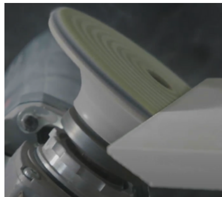
Imagem 99: Finalização do desgaste destes 2mm pelo disco cerâmico.
