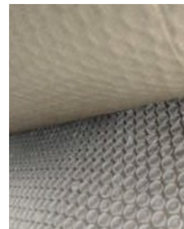
Imagem 45: Protetor de piso. Lado Kraft e bolhas plásticas.
