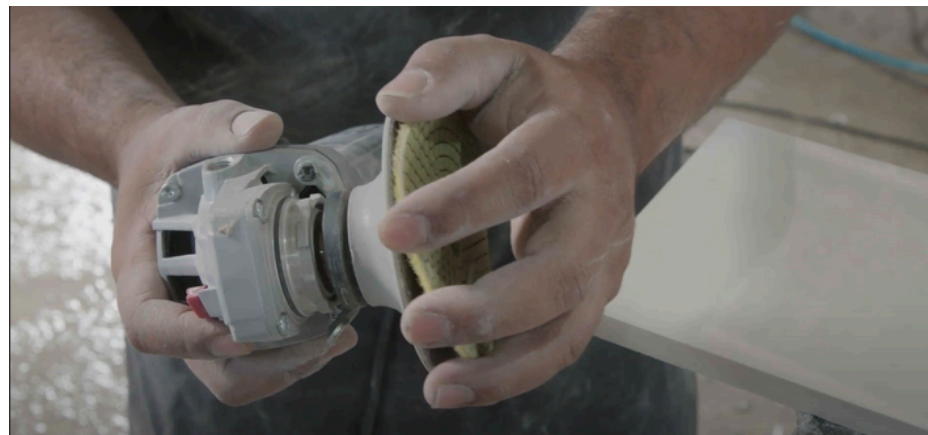
Imagem 102: Acoplagem do disco cerâmico na esmerilhadeira.
