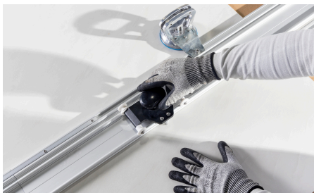
Imagem 62: Encaixe o rodel sobre o trilho
