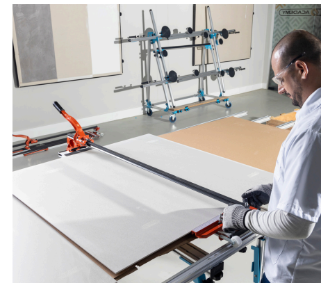
Imagem 51: Encaixa da peça estabilizada sobre o riscador.
