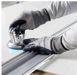
Imagem 61: Fixar o trilho com ventosa na peça.
