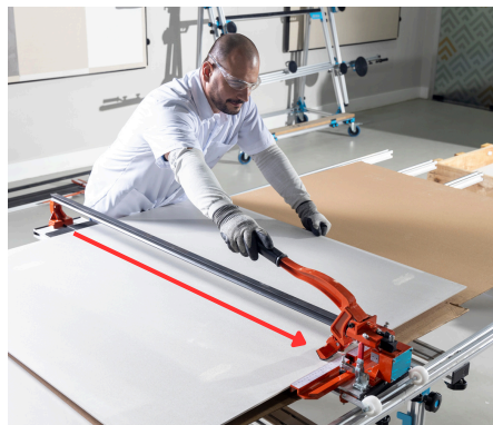
Imagem 55: Complete o risco, empurrando a vidade de uma extremidade a outra.
