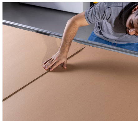
Imagem 49: Camada extra de papelão na parte central da mesa.
