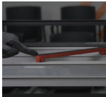
Imagem 50: Ajustes as hastes de apoios laterais do riscador, conforme formato da peça.
