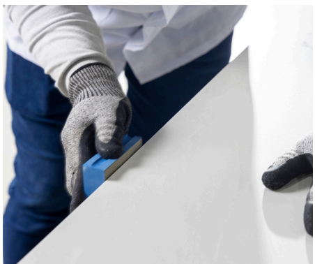
Imagem 100: Utilização da esponja diamantada para acabamento fino.
