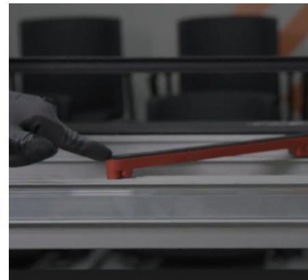
Imagen 50: Ajuste de las varillas de los soportes laterales del rayador, según el formato de la pieza.
