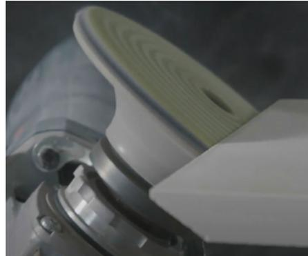
Imagen 99: Finalización del desgaste de estos 2 mm por el disco cerámico.
