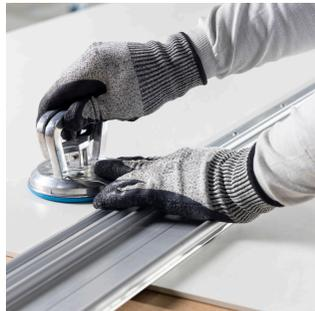
Imagen 61: Fijar el riel con ventosa a la pieza.
