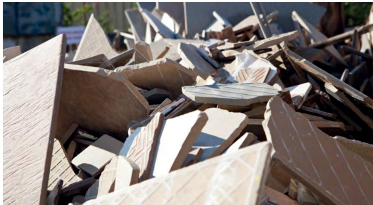
**PRÉ-CONSUMO:** material gerado pela própria empresa ou gerado por empresas terceiras (indústrias, empresas de beneficiamento, distribuidores de revestimento cerâmico) que passou por um reprocesso para ser incorporado a fabricação de revestimento cerâmico (Ex: lodo das estações de tratamento e caco cerâmico).
